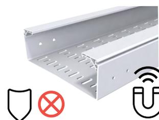
Se um SCC metálico apresenta uma boa continuidade elétrica e está ligado a um sistema de equipotencialização de massa, diminui a incidência da perturbação sobre os cabos ao eliminar a corrente induzida, melhorando a Compatibilidade Eletromagnética (CEM).
