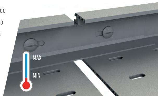
Os nossos sistemas de união utilizam rasgos longitudinais para absorver os movimentos devidos à dilatação térmica. BASOR aconselha a separar as peças deixando espaço para que as uniões atuem como juntas de dilatação e permitir estes movimentos. O comprimento do conjunto de esteiras, a diferença de temperatura de serviço e o material determinam o comprimento máximo do conjunto reto para instalar a união como junta de dilatação.
