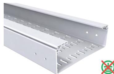
Segundo a norma americana UL 568 "Nonmetallic Cable Tray Systems", os Caminhos de Cabos isolantes deverão resistir ao ensaio ASTM D 149 com a aplicação de uma tensão de 5000V CC durante um minuto sem sofrer perfuração, exceto as calhas desenhadas expressamente para dissipar a eletricidade estática.
