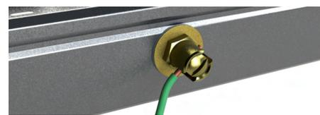
Nas situações onde existam limitações de espaço podem-se instalar circuitos distintos num mesmo SCC divididos por um separador metálico. Com uma correta instalação que garanta a continuidade elétrica, NÃO é necessário incluir um cabo de cobre ao longo de toda a esteira.
