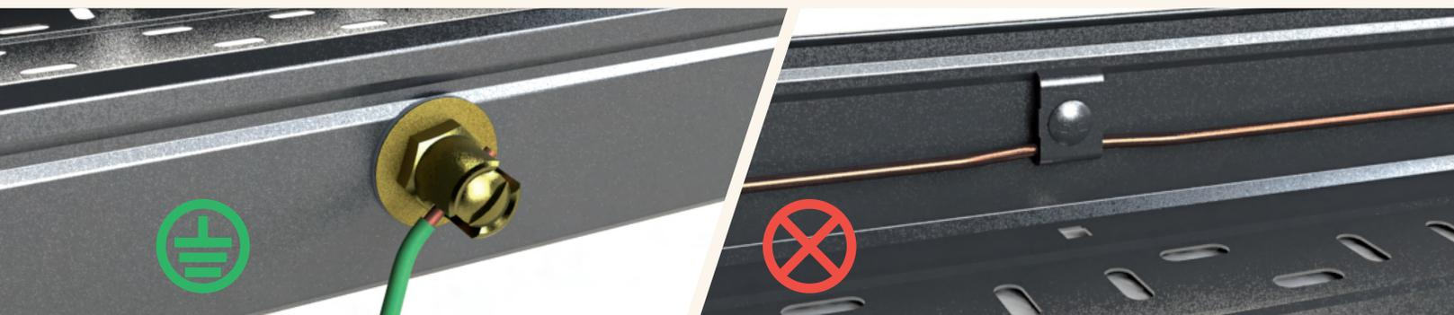
**Em conclusão, as calhas metálicas com revestimento metálico de BASOR ELECTRIC têm continuidade elétrica que assegura uma ligação equipotencial entre si e não necessitam de um condutor de proteção ao longo do seu percurso.**
