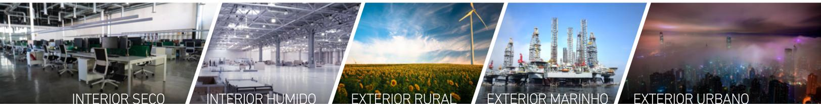
A partir da experiência e do conhecimento adquirido internacionalmente acerca da corrosão, a norma ISO 9223 "Corrosividade de atmosferas" define em função da humidade e da presença de contaminantes, distintas classes de ambientes C1 a C5 segundo o grau de corrosividade nos metais. A mesma classificação é utilizada na ISO 9224 e na ISO 14713-1 "Revestimentos de zinco. Proteção face à corrosão" (ver Secção 8).
